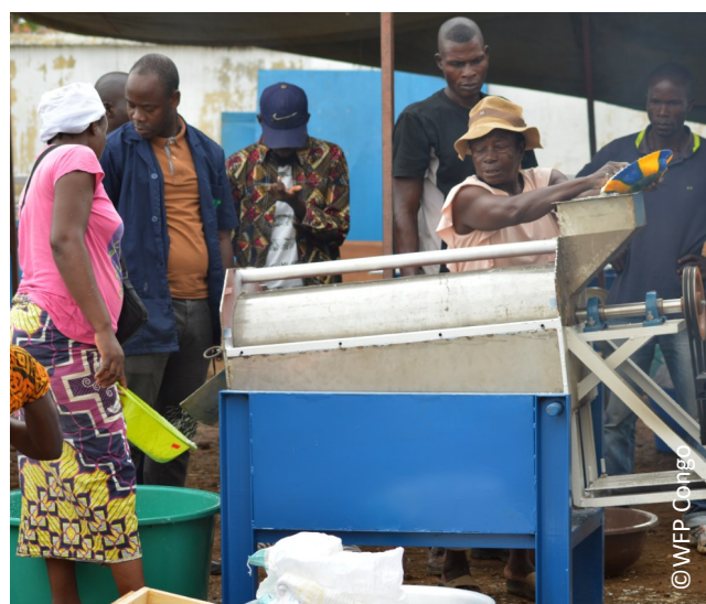
Les bénéficiaires apprennent à utiliser la machine servant à la transformation du manioc en attiéké et en gari.
