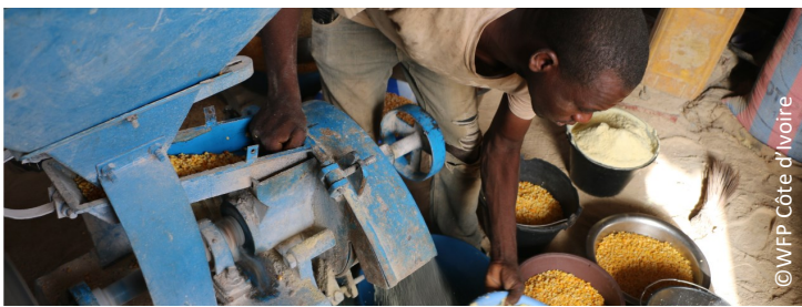
Une vue de la décortiqueuse et du moulin permettant aux bénéficiaires de transformer et mieux conserver les produits alimentaires.
