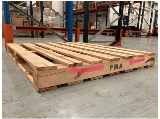
Pie de foto 1: ©WFP — Primer pale tipo WFP realizado con pinus canariensis
